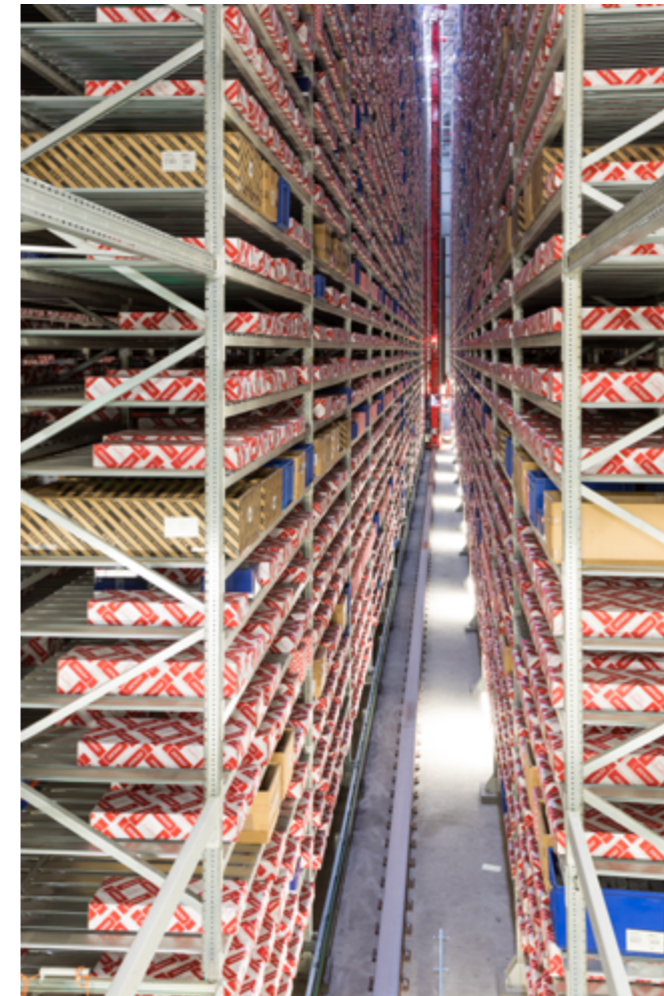
AUTOMATISIERTE LAGERHALTUNG MIT MINILOAD FÜR KARTONS ODER BEHÄLTER MINILOAD AUTOMATED STORAGE SYSTEM FOR CARTONS OR BOXES
