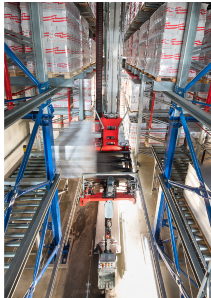
AUTOMATISIERTES LAGERSYSTEM MIT REGALBEDIENGERÄT UND SHUTTLE-LÖSUNG AUTOMATED STORAGE & RETRIEVAL SYSTEM WITH SHUTTLE AND STACKER CRANE
