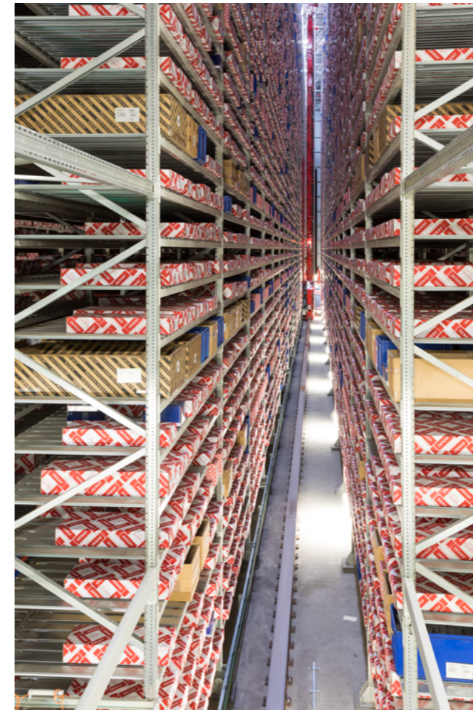
AUTOMATICO CON MINILOAD PER SCATOLE O CASSETTE MINILOAD AUTOMATED STORAGE SYSTEM FOR CARTONS OR BOXES
