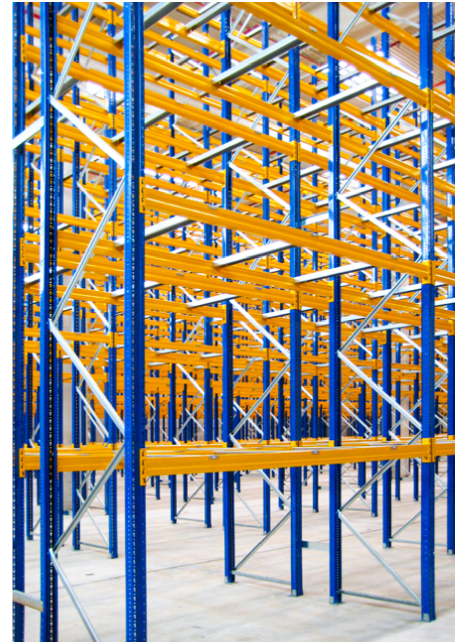
Palettenregal Pallet Racking
